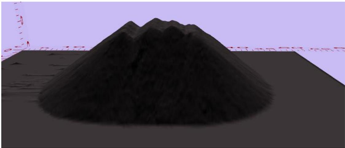
通过构建不规则三角网，被测物料形状被分解成数以万计的三棱柱体，计算每个三棱柱体的体积，对所有三棱柱体积进行累加，就得到被测物料的体积。同时软件可以实现对被测物体的分割计算。
